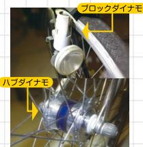
ハブダイナモは前輪の車軸に発電機がついており、前輪が回転する事により発電する。
